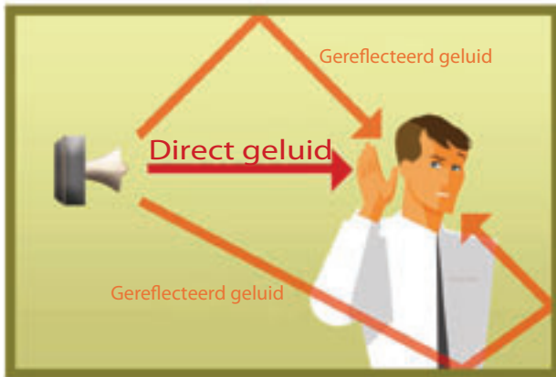
Figuur 3.1: Geluid afkomstig van een akoestische bron wordt gereflecteerd door de wanden van de werkplek. De blootstelling van de werknemer is een combinatie van direct geluid en gereflecteerd geluid.
