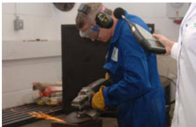
Figuur 2.11 Meting van het geluidsniveau bij het oor van een werknemer. Foto © en met toestemming van Health and Safety Executive, Groot-Brittannië.
