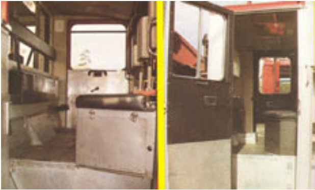
Figuur 4.16 Transport – Het geluid in de cabine van dit voertuig bestemd voor personenvervoer wordt verminderd door de vloer en de zijwanden te bekleden met glasvezel met daarop plaatstaal en andere oppervlakken met absorberend materiaal
