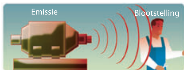
Figuur 6.1 Een lagere geluidsemissie van de machine resulteert in lagere blootstelling van werknemers
