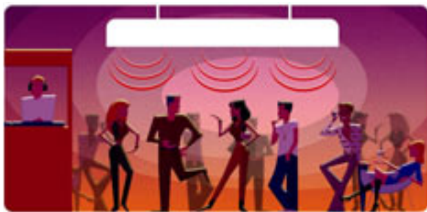
Figuur 8.1 Discotheek met akoestisch plafond met verschillende ingebouwde luidsprekers in plaats van twee hoofduidsprekers
