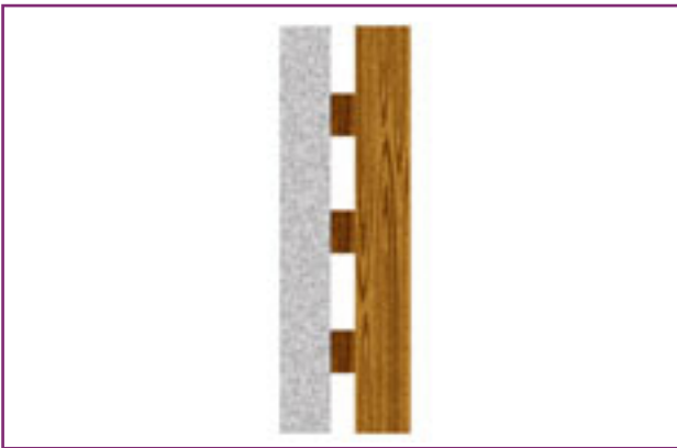
Figuur 3.7 "Diafragma's" zijn houten panelen die op latten tegen de wand worden bevestigd om geluid met een lage frequentie te dempen.
