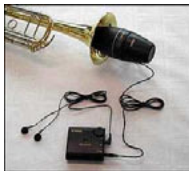
Figuur 8.4 Silent-brass-systeem Foto © & met toestemming van Yamaha Music
