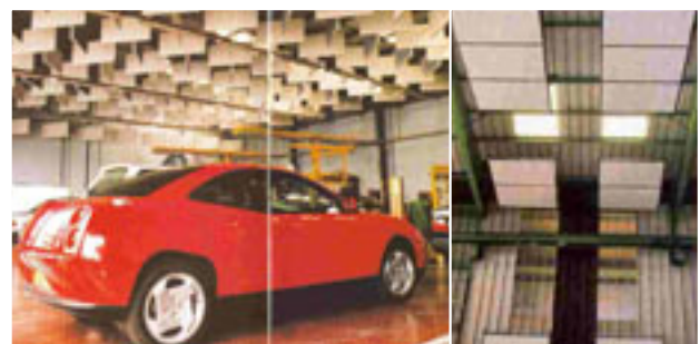
Figuur 4.19 Garage - Ruimteabsorptie © Yves Cousson - Met dank aan INRS – Frankrijk
