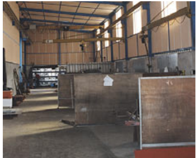
Figuur 4.18 Metaalbewerking - Scherm © Yves Cousson - Met dank aan INRS – Frankrijk
