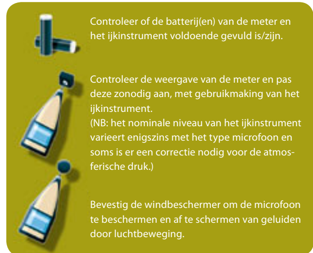
Figuur 2.10 IJking: instructies van de fabrikant
