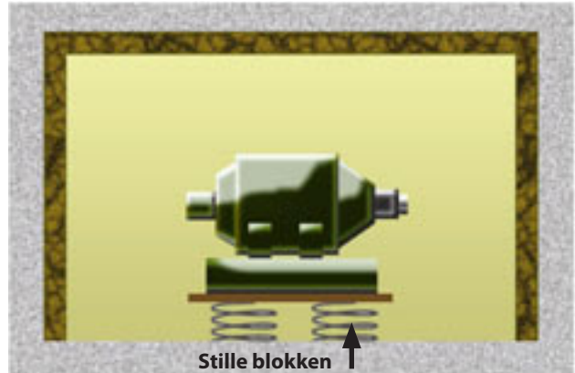
Figuur 4.14 Plaats luidruchtige apparatuur in een omkasting
