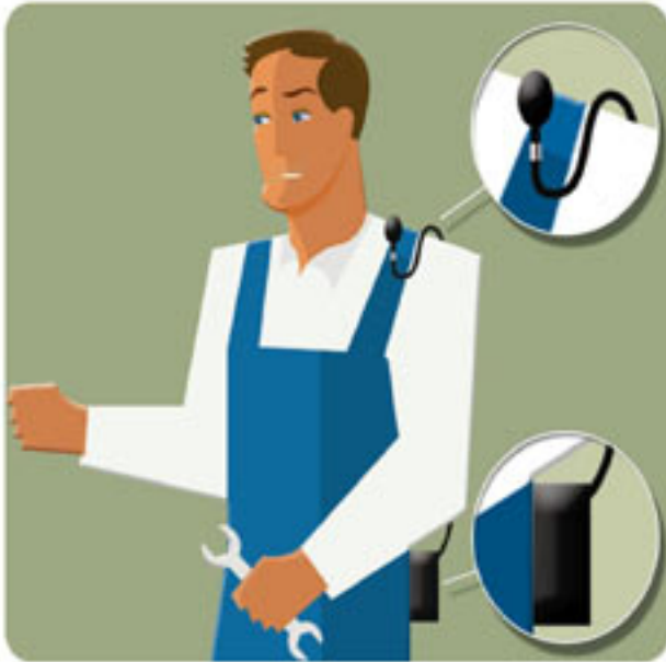
Figuur 2.12 Dosimetermicrofoon bevestigd op de schouder
